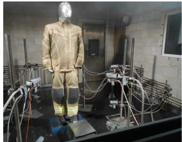
Figure 4. Execution of the fire test using the RALPH mannequin in the BTTG Manchester laboratory Rycina 4. Realizacja testu ogniowego z wykorzystaniem manekina RALPH w laboratorium BTTG Manchester Source / Źródło: R. Wolański.
