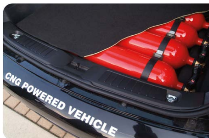
Figure 2. Compressed gas cylinders for CNG propulsion Rycina 2. Butle ze sprężonym gazem dla napędu CNG
