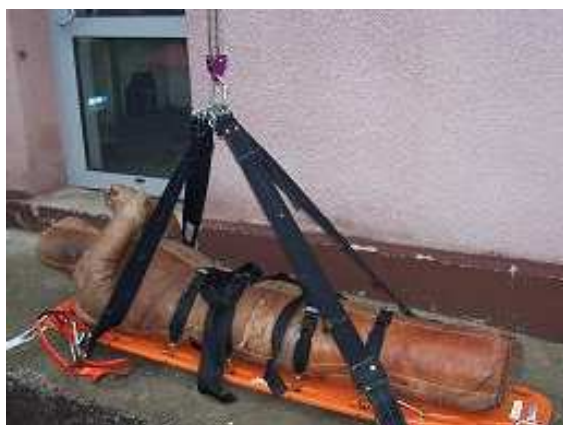
Fot. 7. Sposób zabezpieczenia poszkodowanego i zamocowania noszy pasami strażackimi
