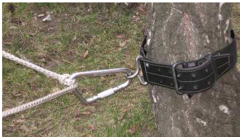
Fot. 4. Węzeł mocujący w stałym punkcie asekuracji
