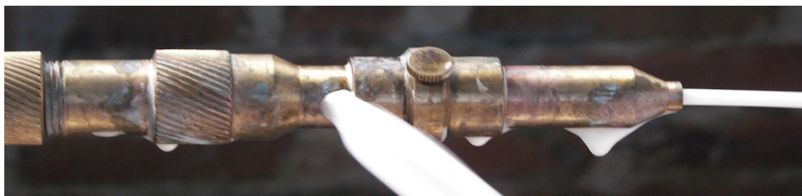
Fot. 2 Widok fragmentu prądownicy podczas przepływu piany
